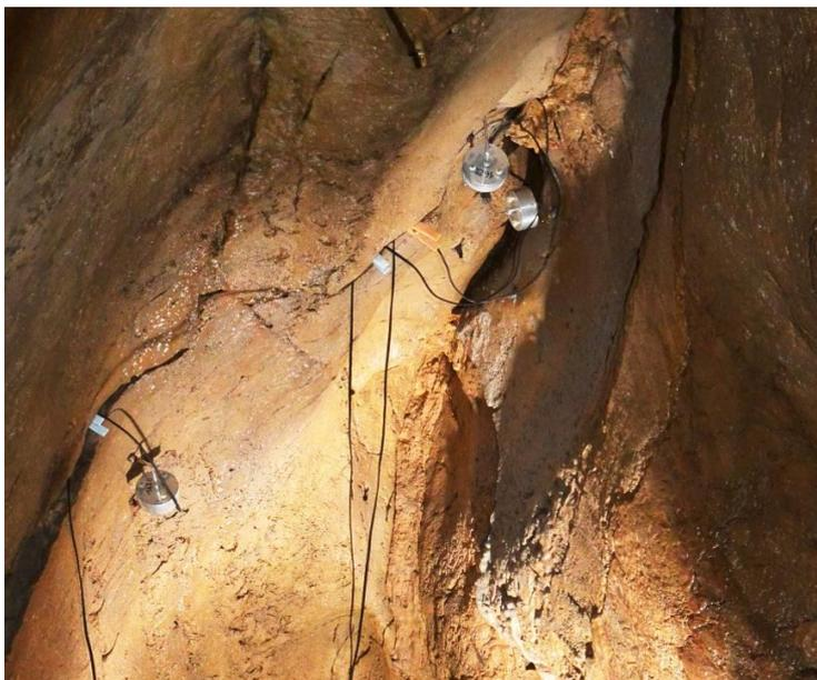
**Figure 5a (ci-dessus).** Le premier extensomètre à être installé. Il est constitué de deux plaques accrochées respectivement aux deux flancs de la faille. Il fonctionne sur le principe du condensateur électrique : si les plaques s'écartent ou se rapprochent, la tension, mesurée, change.
