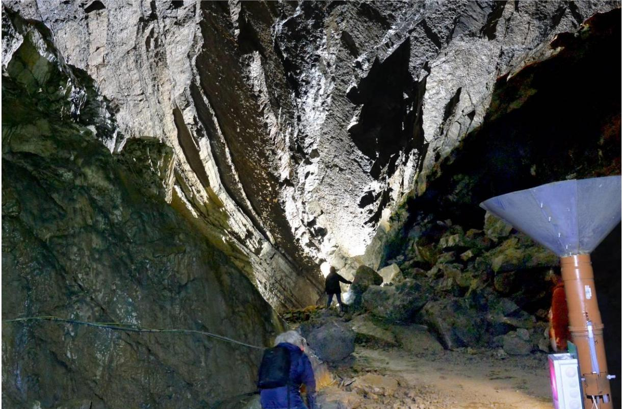
*La salle du Val d'Enfer. A droite, on voit le dispositif qui mesure les caractéristiques physico-chimiques et les traceurs des eaux d'infiltration.*
