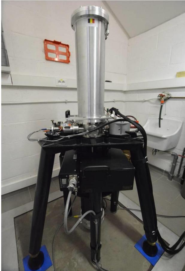
**Figure 7 (ci-contre). Le gravimètre absolu.** Il mesure le mouvement d'une masse tombant dans le vide et en calcule le facteur  $g$ . Photo : F. Boulvin.
