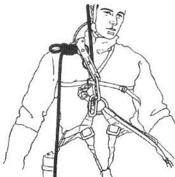
Installer le basic (bloqueur) au dessus du descendeur, en un point tel que le haut du mousqueton de la longe courte (tendue vers le haut) arrive dix centimètres sous le dessus du bloqueur basic.
