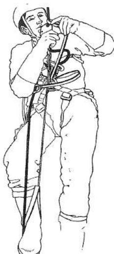
Détendre la jambe, le mousqueton de la petite longe vient en butée sur le bloqueur, le descendeur n'est plus en tension.
