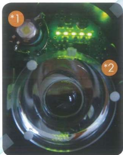
En haut à gauche, la LED non focalisée *1. En bas, la lentille de focalisation de la deuxième LED *2. On distingue les 5 petites LEDs vertes servant à dialoguer avec la lampe.
