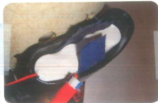
Figure 3 : Bandelette de tissu destinée à faciliter l'extraction des batteries - Cliché: Luc Bourguignon
