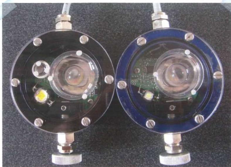
Pour garder la consommation électrique -et donc l'autonomie- dans des limites acceptables, ainsi que pour éviter des problèmes de surchauffe, la LED P7 n'est alimentée qu'à 1,3A au lieu des 2,8A qu'elle peut en principe accepter. Le flux lumineux est annoncé à 370 Lumens, à comparer avec les 240 Lumens de la Scurion standard.
