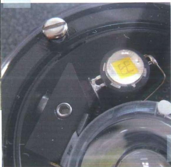
Figure 3 : La nouvelle diode Séoul P7. Observez le biseautage du basculeur du bouton de commande, nécessaire pour faire de la place à cette grande LED.
