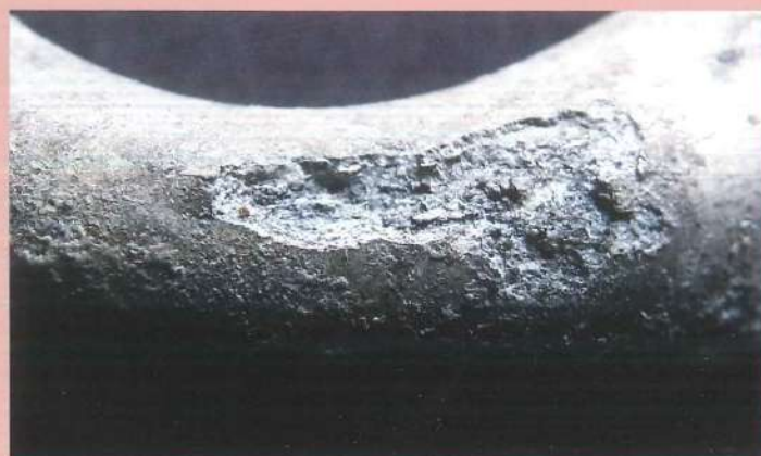
Fig. 3: Point de corrosion bien visible, avec écaillage des couches externes et cristaux d'alumine
