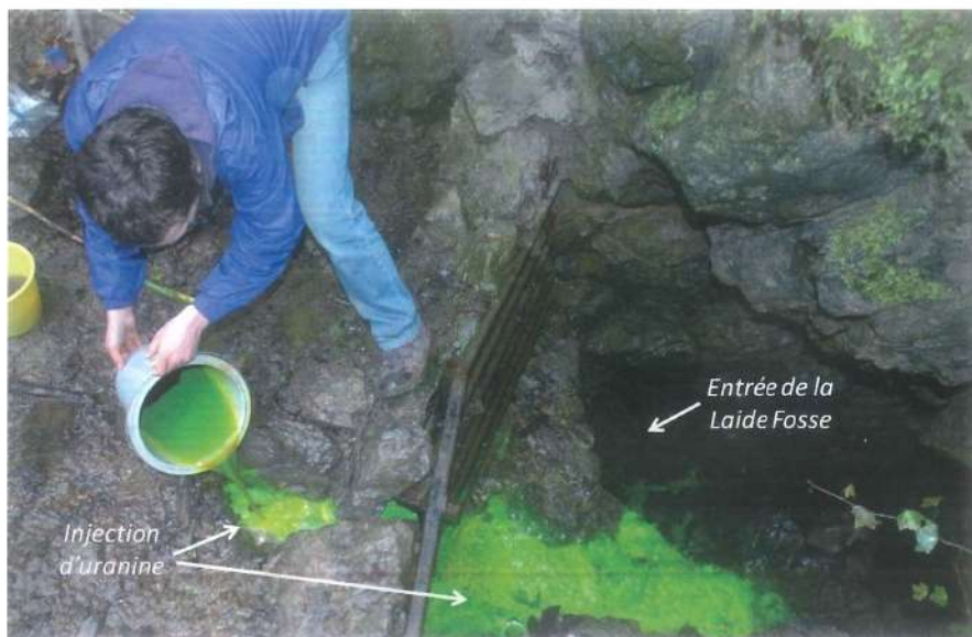
Fig. 5: Injection d'uranine au Chantoir de la Laide Fosse. Photo FUNDP
