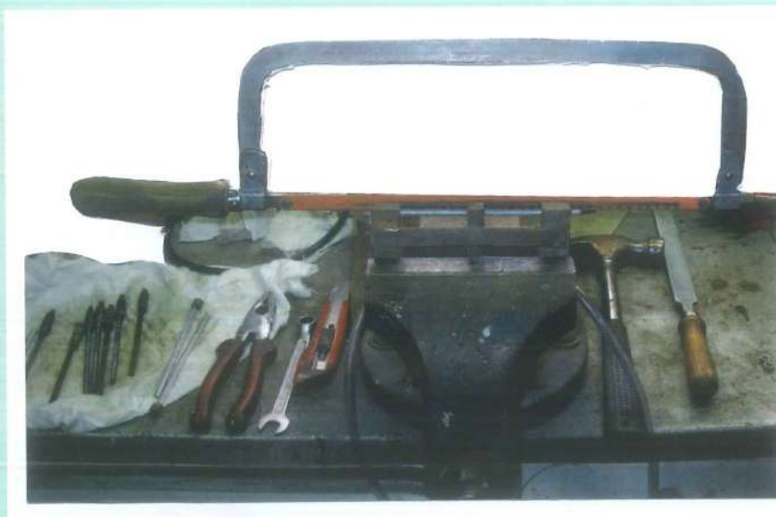
Outillage utilisé pour réaliser la rainure sur la tige M6.
