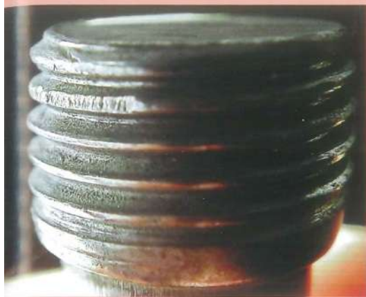
Arrachement du filet sur un maillon mal vissé.
