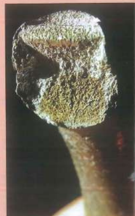
Détail de la corrosion interne (zones sombres)
