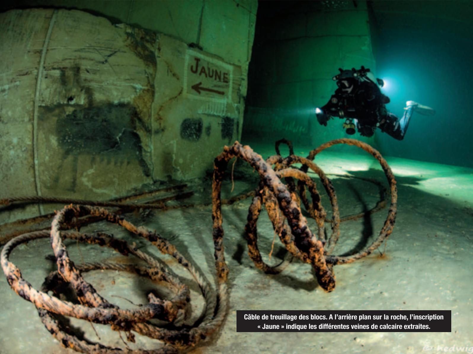
Câble de treuillage des blocs. A l'arrière plan sur la roche, l'inscription « Jaune » indique les différentes veines de calcaire extraites.
