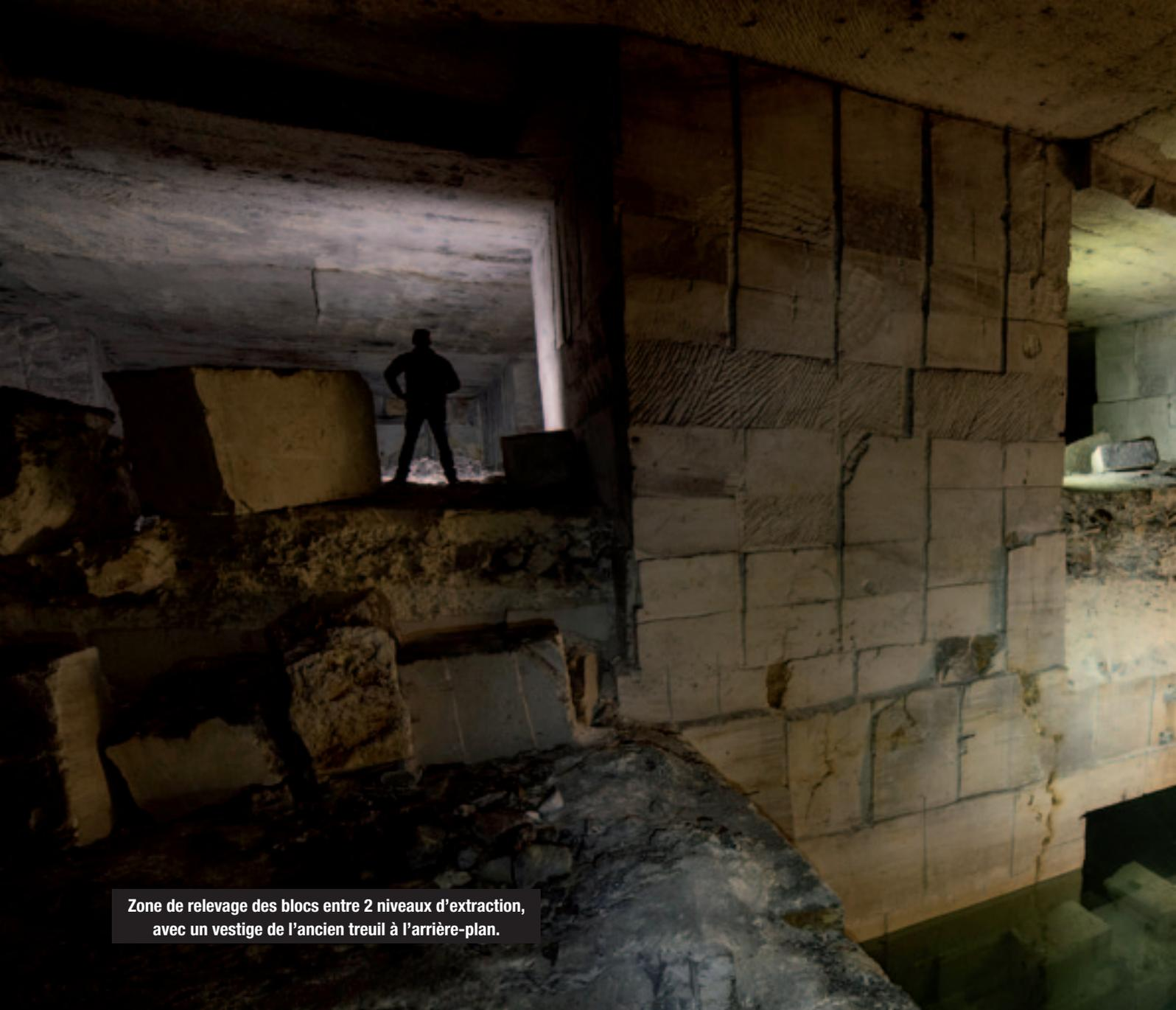
**Zone de relevage des blocs entre 2 niveaux d'extraction, avec un vestige de l'ancien treuil à l'arrière-plan.**
