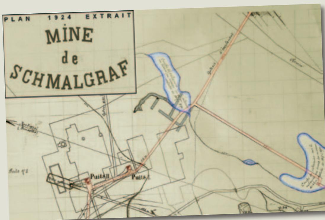
Figure 8 – Plan des travaux miniers, extrait (Grignard, 1924). En orangé, la galerie Oskar (g. d'écoulement) ; en bleu, les deux petits gîtes situés au-dessus de l'étage des 42m ; en grisé, les travaux miniers dans le gîte Est.
