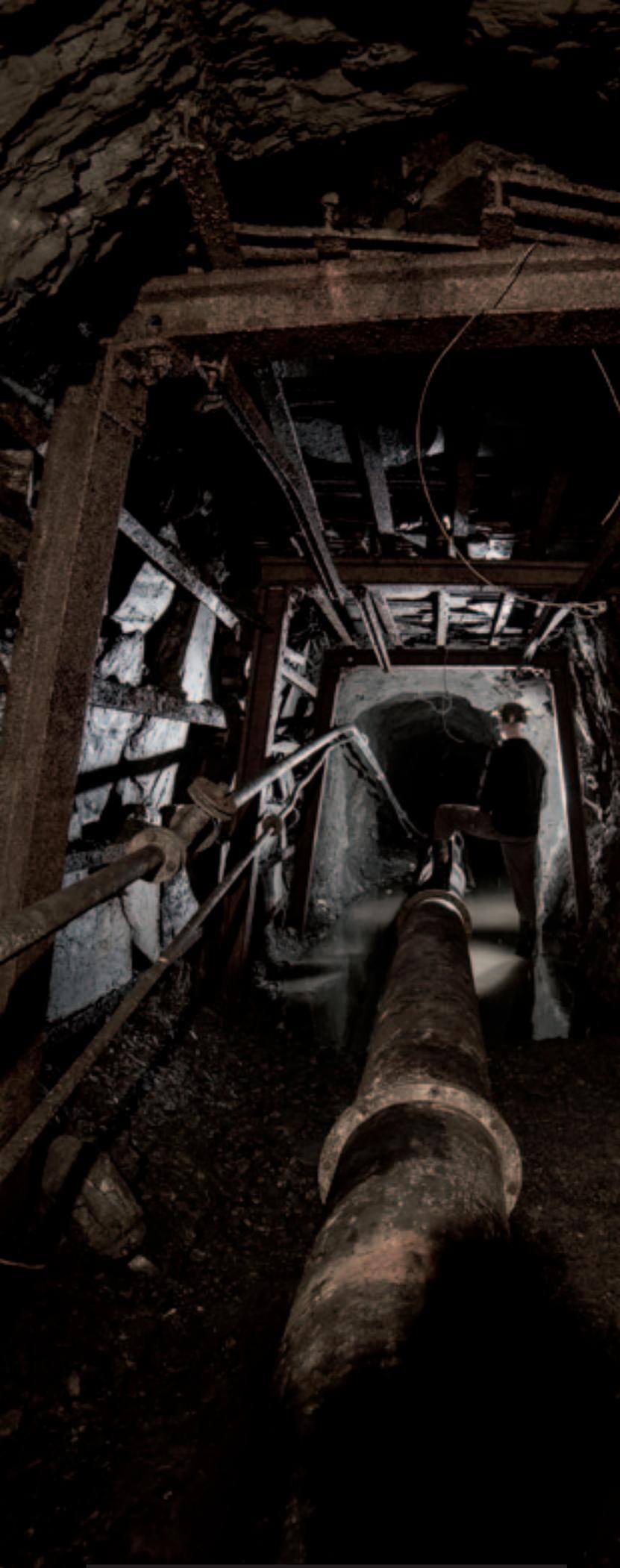
L'énorme tuyau destiné à ventiler les chambres situées au fond de la galerie de roulage Est, jadis suspendu au plafond.
